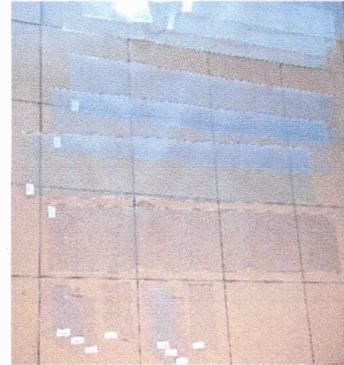
**Die Bedingungen der Klimaanlage:** bis zur Gewichtskonstanz und der 14 Tage vor die Untersuchungen auszuführen, in einer Temperatur 23±2 °C und die Feuchtigkeit 50±5 % (DIN 50014-23 / 50-2).
